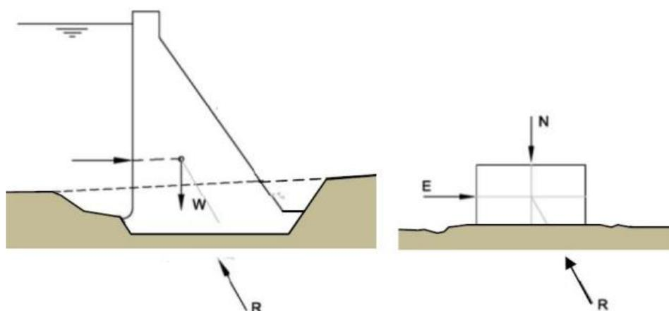
Para ello, se utilizan bloques rectangulares de roca tallados o bloques fabricados de hormigón armado, de dimensiones requeridas (normalmente entre 0.5m x 0.5m x 0.5 m y 1m x 1m x 1m), aislados en todas las caras, excepto en la base, que deberá situarse coincidiendo con la superficie del plano de corte que se desea ensayar, y que posteriormente se harán deslizar. Hay distintas posibilidades de materializar el ensayo, desde 1 a 4 bloques.
