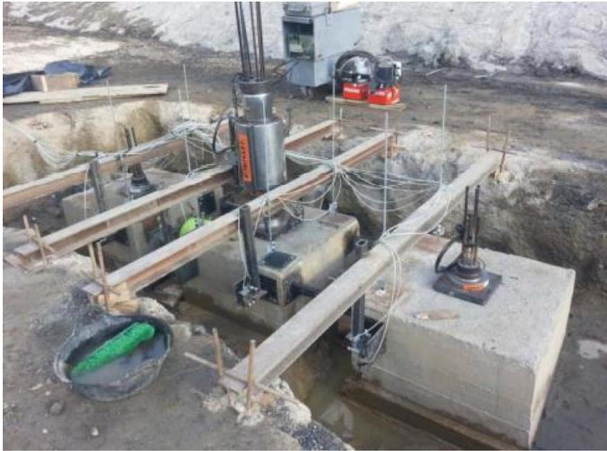
La interpretación del ensayo es directa. Se miden cargas y desplazamientos en dirección horizontal y vertical. Se obtienen resultados sobre la deformabilidad de la diaclasa ensayada (módulos normal, transversal y de dilatación), así como los parámetros más plausibles de su resistencia al corte (cohesión y ángulo de rozamiento). La razón de ensayar bloques de gran tamaño suele ser el análisis de la influencia de rugosidades de gran escala en la resistencia.
