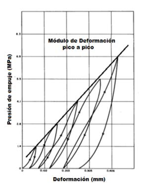
Instrumentación Geotécnica y Estructural, S.L. (INGE), dispone de todo el aparataje necesario para la realización de este tipo de ensayos según la Norma ASTM D4395 "Standard Test Method for Determining the In Situ Modulus of Deformation of Rock Mass Using the Flexible Plate Loading Method":
