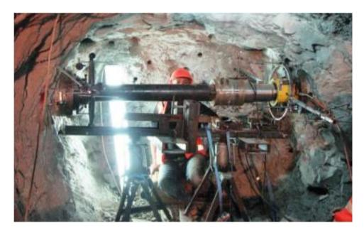
El tamaño de la placa estará determinado por la geología local, las presiones a aplicar y el tamaño de la cavidad a probar. Estos parámetros deben considerarse antes de la excavación de la cavidad. Las dimensiones óptimas
